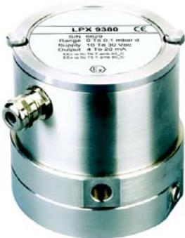
LP9000 系列可准确地测量气体和液体的微压差或相对压力，其满量程从 10KPa 到 1MPa。选择相应的电流输出或电压输出，它们可适应单向（例如 0 到 2KPa）或双向（例如 -2KPa 到 +2KPa）压力测量。
