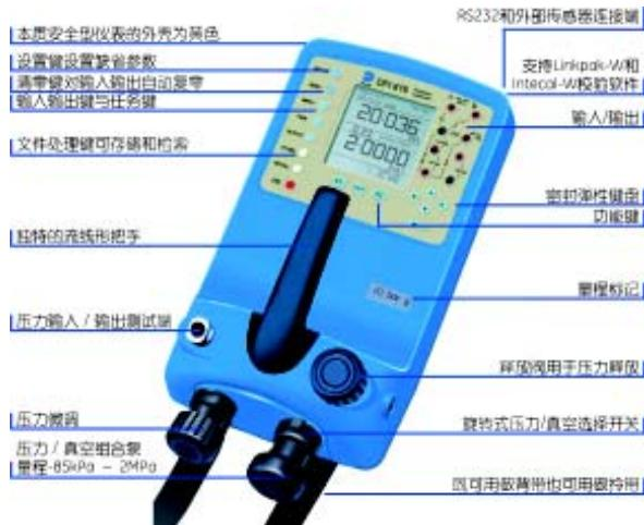
DPI610/615 为 一体式电池供电仪表，自备压力源，具有压力控制微调、电源输出和测量等功能，同时还可提供4~20mA回路测试和数据储存。仪表结构坚固紧凑。屏幕宽，双参数显示，使用户在操作DPI610/615手泵和连接测试线时，仍能清晰地读出参数。面板键盘具有弹性好、手感好和寿命长等优点。毫安阶跃和斜率输出以及内部的持续测试功能方便了对回路控制的维修和保养。
